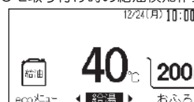
●OC-2取り付け時の給油検知作動表示
