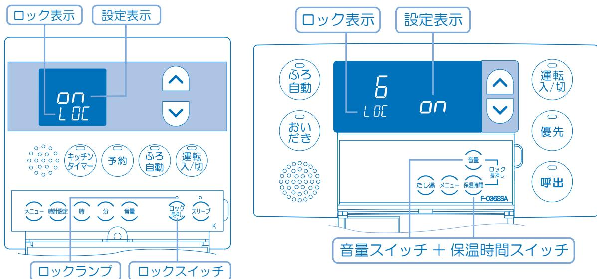
チャイルドロック中に運転スイッチ、呼び出しスイッチ以外のスイッチを押すと、「ピピッ」と音が鳴り、リモコンに「
