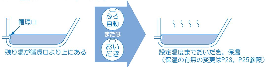
ふろリモコンのたし湯スイッチを押すと、設定された量をお湯はりした後、設定ふろ温度までおいだきして保温します。
